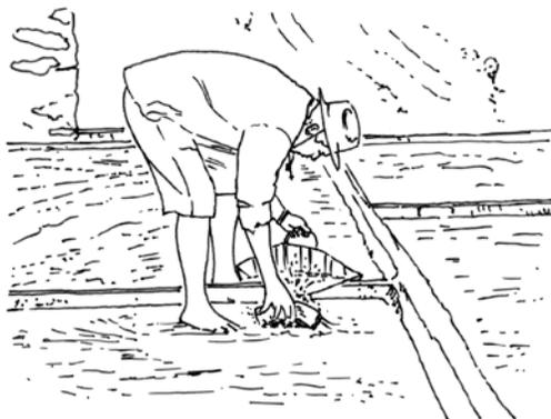
Figura 1. Regresando el agua salada a un estanque previamente lavado, usando una bolsa como tamiz. Zapotitlán, Puebla.
